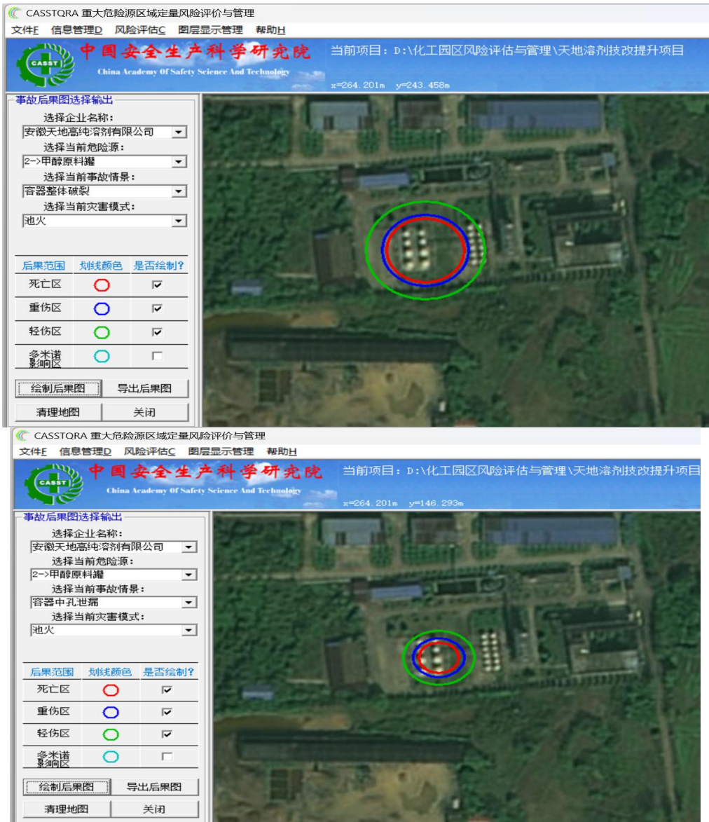
(2) 罐区甲醇原料罐甲醇泄漏发生火灾事故模拟结果:
